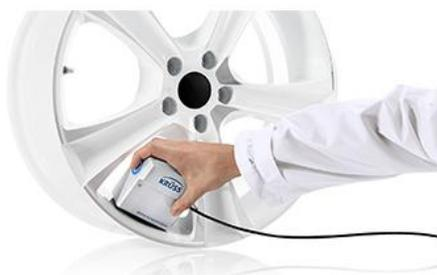
便携式接触角测量仪MSA，一键式测定待测固体接触角和表面自由能，一秒完成，操作简单，甚至可倒置垂直滴液，适用于任何表面，包括曲面产品质量控制和研发，完全取代测试墨水法。
